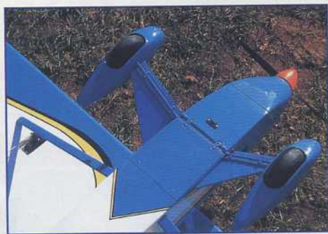
Les dessous de l'affaire : Deux trappes distinctes pour l'accès à la radio et au réservoir, séparées par le train d'atterrissage, fixé sur une traverse en bois dur.
