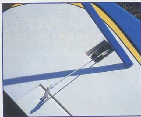
Chaque aileron est commandé par un servo en attaque directe.
